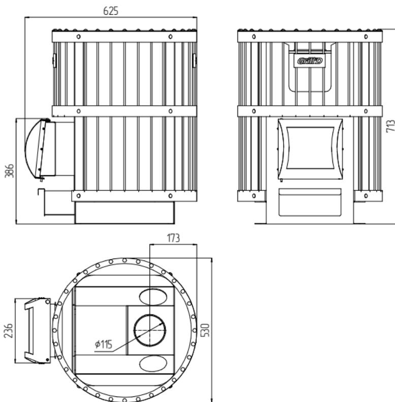
**Рис. 1** Размерные характеристики печи «Grill'D» Leo 130 Short
