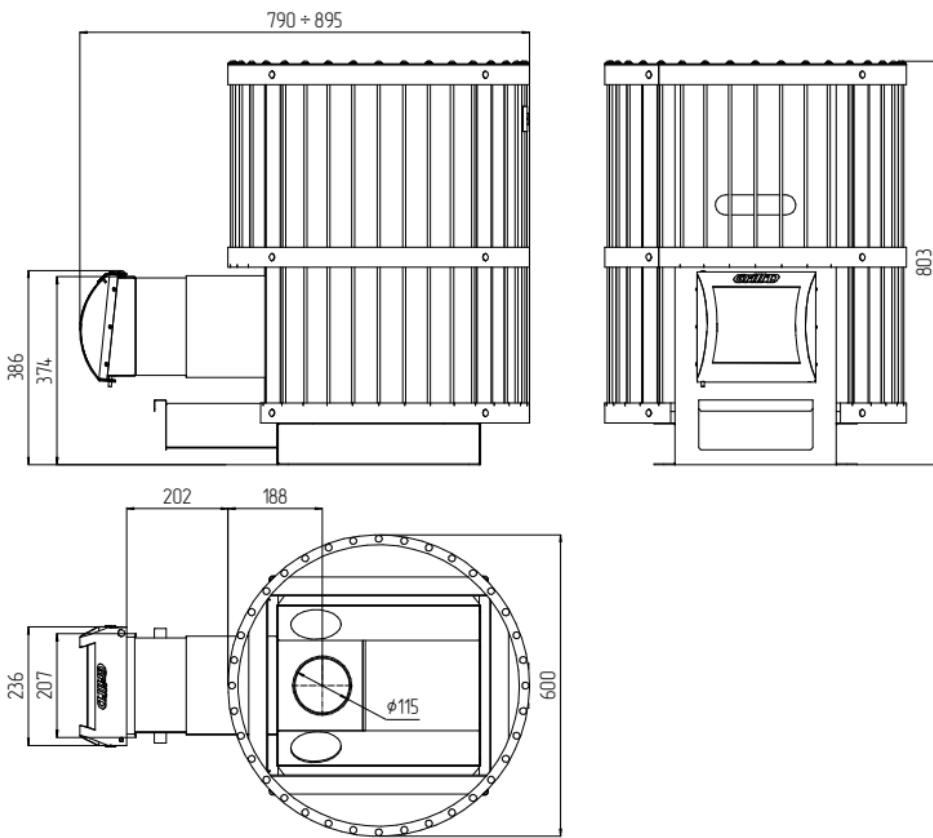
**Рис. 4** Размерные характеристики печи «Grill'D» Leo 240 Long
