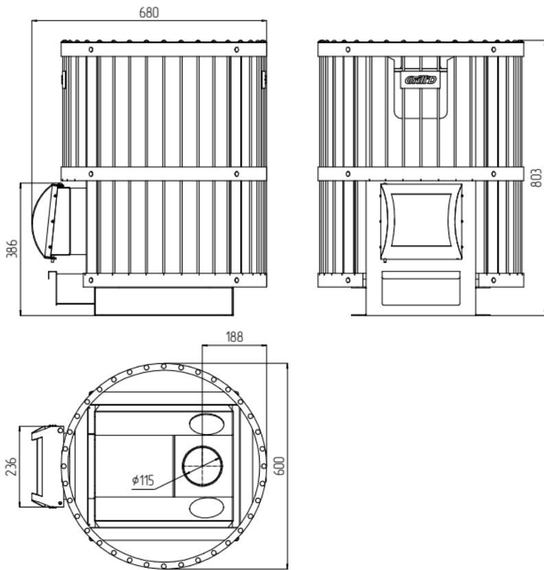
Рис. 3 Размерные характеристики печи «Grill'D» Leo 240 Short
